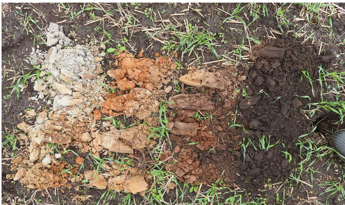
Foto 2 Boring 11: een laarpodzolgrond (40 cm cultuurdek op een humuspodzol)
